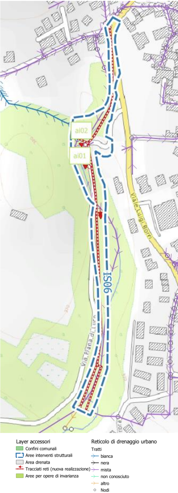
Figura 29 - Intervento strutturale IS06 – Via Piana di Luco.
